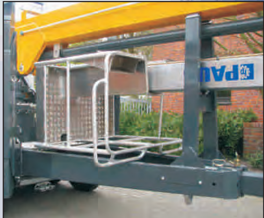
Transport auch mit montiertem Arbeitskorb möglich
