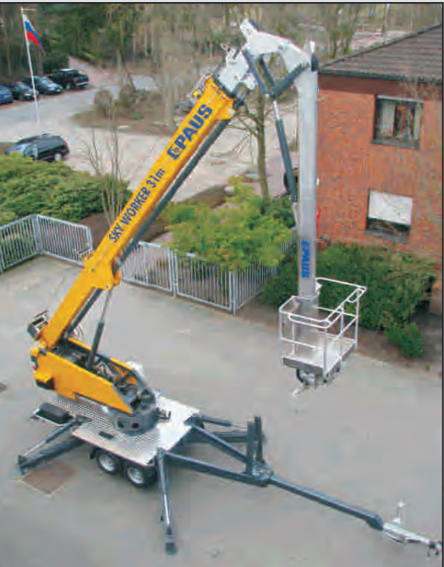
Einsatz als vollwertige Arbeitsbühne mit Arbeitshöhe von 25 m
