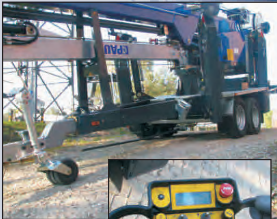
hydraulischer Fahrtrieb über Funkbedienung
