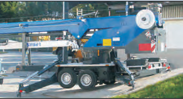
leichtes Aufstellen durch automatische Selbstnivellierung vom Bedienpult aus
